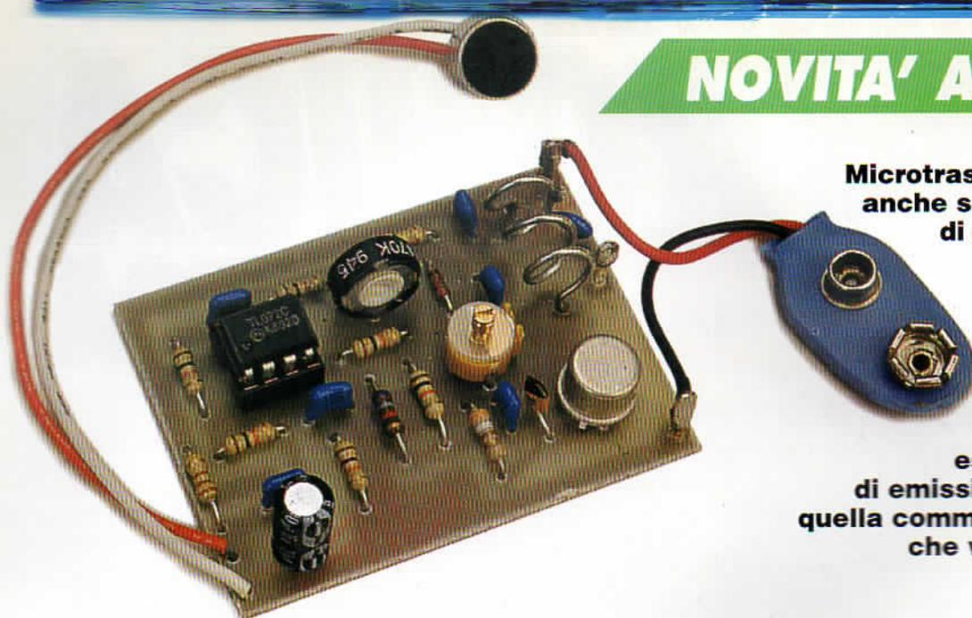
**Microtrasmettitore che funziona anche senza antenna. È dotato di eccezionale sensibilità e di massima stabilità di frequenza. Può fungere da radiomicrofono e microspia: è in dimensioni tascabili, con particolare estensione della gamma di emissione, che può uscire da quella commerciale, ha una portata che va dai 100 ai 300 metri.**
