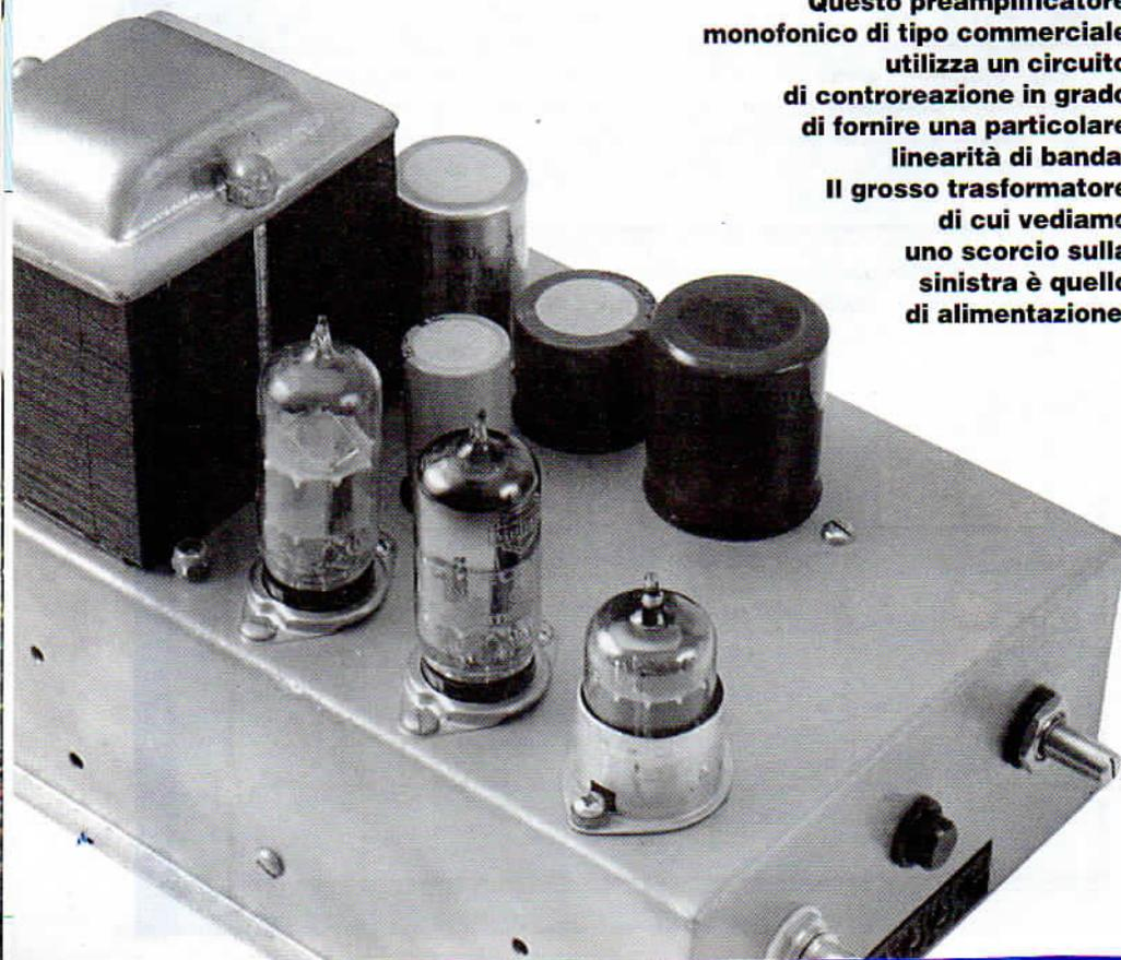
Esistono, poi, due diversi sistemi per ottenere la controreazione: poiché sia la tensione sia la corrente che si ottengono all'uscita hanno l'andamento del segnale d'ingresso, entrambi possono essere impiegati a tale scopo.
